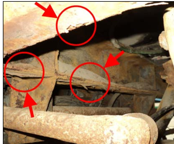
FIGURE 3: ÉCAILLAGE DU MÉTAL ET ACCUMULATION DE SABLE
