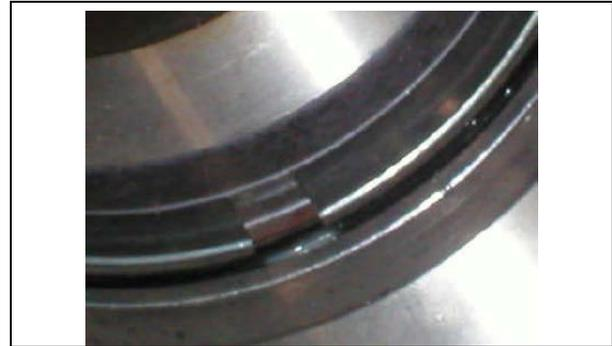
5. Nettoyer la rondelle de butée des deux côtés et l'écrou du moyeu en utilisant du dégraissant EFX.
