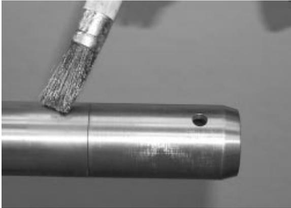
FIGURE 10 : APPLIQUER LA GRAISSE GLEITMO 805.
