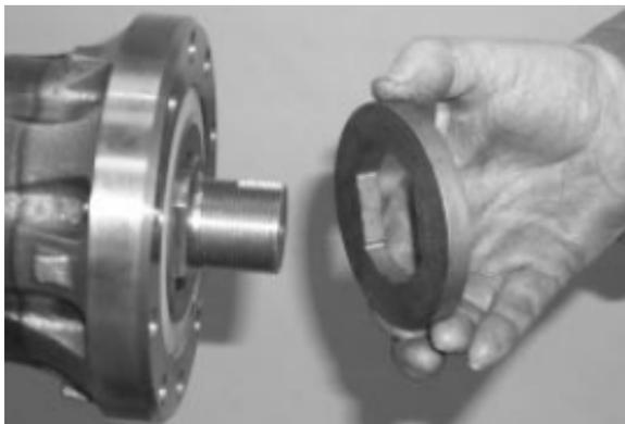
FIGURE 21 : POSER LA RONDELLE DE BUTÉE
