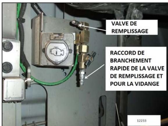
FIGURE 6 : EMBLACEMENT DE LA VALVE ARRIÈRE (typique)
