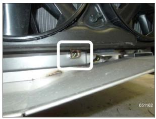
FIGURE 9: FAN SHROUD TOP & BOTTOM HOLD-DOWN SCREWS
