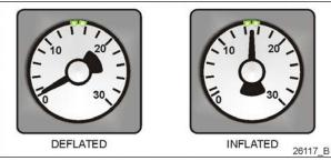
FIGURE 9: INFLATABLE SEAL PRESSURE GAGE
