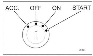
FIGURE 2: IGNITION SWITCH KEY POSITIONS
