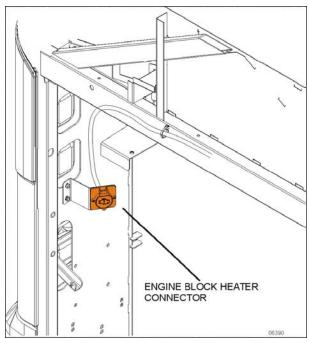
FIGURE 5: ENGINE BLOCK HEATER CONNECTOR (TYPICAL)
