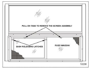
FIGURE 2: ELECTRIC SLIDING WINDOW
