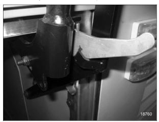
FIGURE 31: BAGGAGE DOOR LOCK AND LEVER
