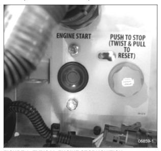
FIGURE 1: TYPICAL ENGINE STOP/ IGNITION INTERLOCK BUTTON
