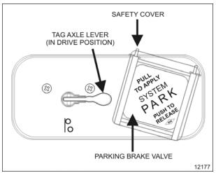
FIGURE 14: PARKING BRAKE CONTROL VALVE
