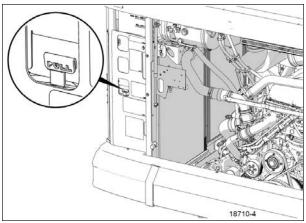
FIGURE 14: RADIATOR DOOR RELEASE LEVER LOCATION
