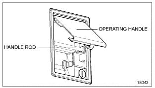
FIGURE 30: BAGGAGE DOOR LOCK AND LEVER
