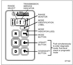
FIGURE 34: ALLISON PUSHBUTTON SHIFT SELECTOR
