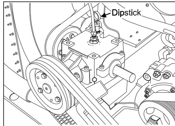
RADIATOR FAN GEARBOX OIL LEVEL DIPSTICK 05062
