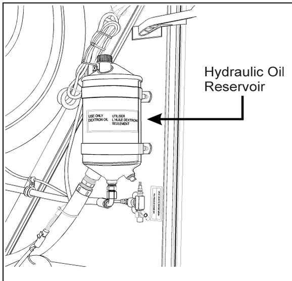
POWER STEERING HYDRAULIC FLUID TANK 14043
