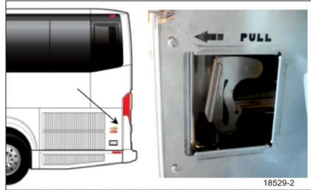
**FIGURE 8: RADIATOR DOOR LATCH RELEASE LEVER LOCATION**
