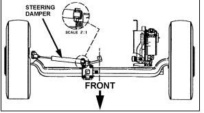
FIGURE 9: STEERING STABILIZER (DAMPER) 14053
