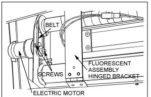
FIGURE 19: DESTINATION SIGN-ELECTRIC MOTOR23034
