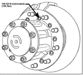
FIGURE 38: TORQUE SPECIFICATION 12140
