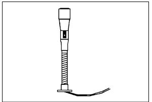
FIGURE 7: BOOM-TYPE MICROPHONE
