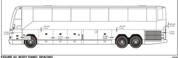
FIGURE 43: BODY PANEL SPACING
