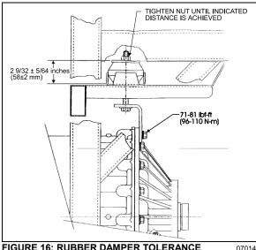
FIGURE 16: RUBBER DAMPER TOLERANCE
