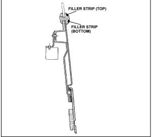
FIGURE 41: WINDSHIELD INSTALLATION SIDE VIEW 8099
