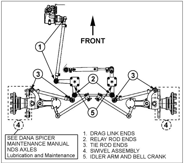
FIGURE 13: LUBRICATION FITTINGS' LOCATION DIAGRAM
