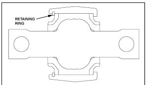
FIGURE 17: UPPER A-ARM BALL JOINTS
