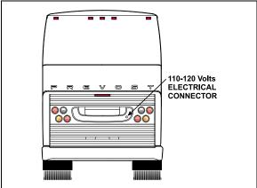
FIGURE 30: ELECTRIC HEATER PLUG LOCATION 06481
