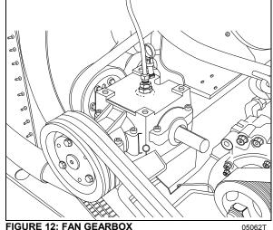
FIGURE 12: FAN GEARBOX
