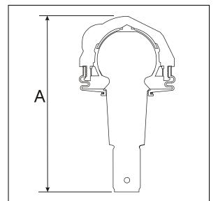
FIGURE 19: UPPER A-ARM CENTRAL BALL JOINT 16116
