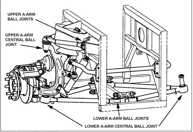
FIGURE 14: BALL JOINTS LOCATION
