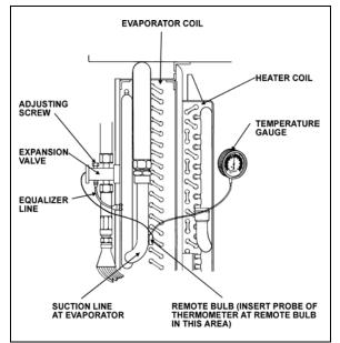
FIGURE 31: SUPERHEAT ADJUST. INSTALLATION 22046
