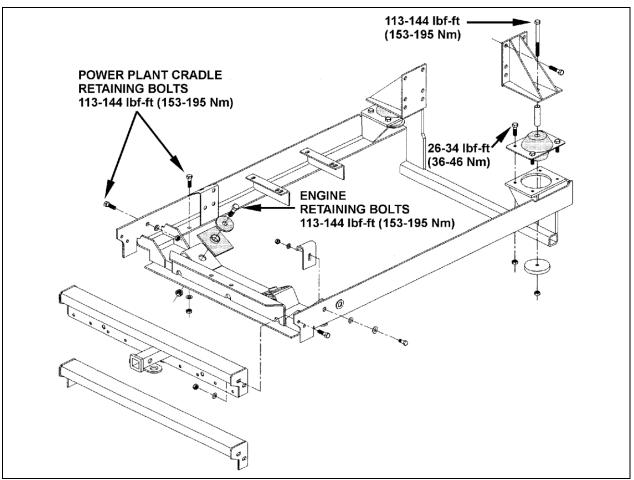
FIGURE 17: POWER PLANT CRADLE INSTALLATION
