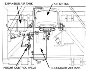
FIGURE 27: HEIGHT CONTROL VALVE LOCATION 16057
