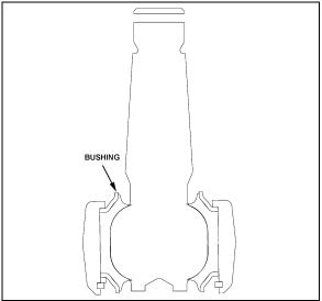
FIGURE 18: LOWER A-ARM CENTRAL BALL JOINT
