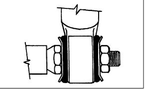
FIGURE 8: TYPICAL SHOCK ABSORBER SETUP 16009
