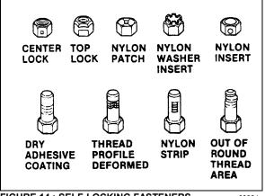
FIGURE 14 : SELF-LOCKING FASTENERS
