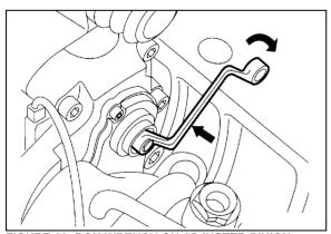
FIGURE 26: BOX WRENCH ON ADJUSTER PINION 12118
