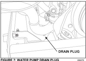
FIGURE 7: WATER PUMP DRAIN PLUG
