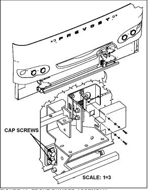
FIGURE 10: FRONT BUMPER ASSEMBLY
