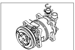
FIGURE 35: LOOSENING THE DISCHARGE SIDE CONNECTOR'S CAP
