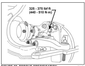
FIGURE 37: TORQUE SPECIFICATION
