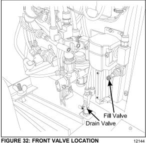
FIGURE 32: FRONT VALVE LOCATION
