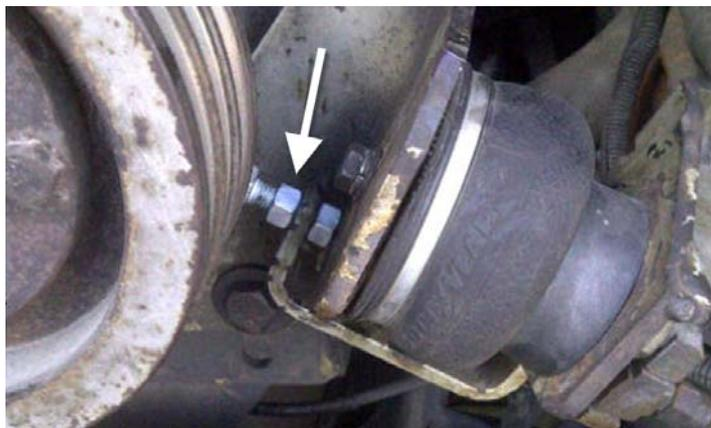
**WITH THE ENGINE RUNNING, MAKE SURE THAT THE BELTS DO NOT RUB AGAINST THE BELLOWS OR THE BELLOWS ATTACHMENT BRACKETS.**
