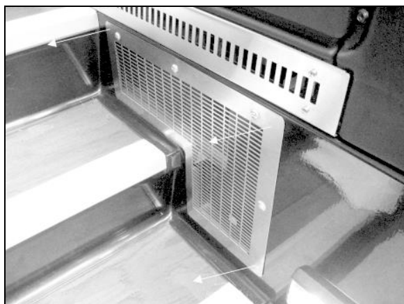
FILTRES À AIR DE LA SECTION DU CONDUCTEUR
