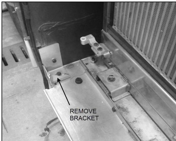
FIGURE 49: RADIATOR DOOR LOWER HINGE BRACKET
