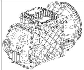
FIGURE 3: VOLVO I-SHIFT TRANSMISSION
