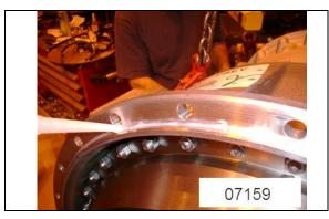
FIGURE 12: SILICONE APPLICATION TRANSMISSION HOUSING
