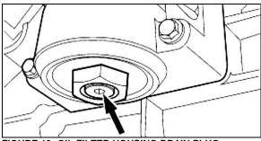
FIGURE 19: OIL FILTER HOUSING DRAIN PLUG
