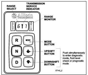
FIGURE 2: ALLISON PUSHBUTTON SHIFT SELECTOR
