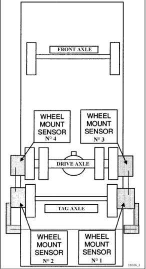
FIGURE 16: TAG AXLE ALIGNMENT
