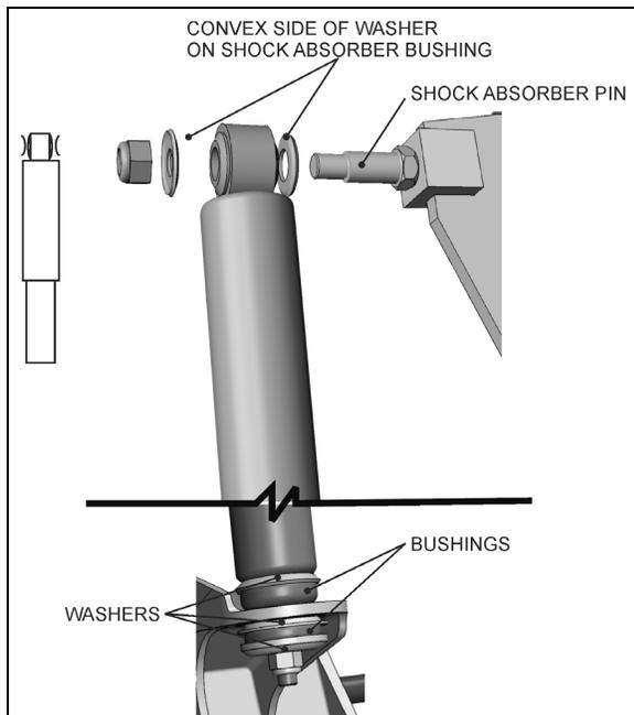
FIGURE 39: TYPICAL SHOCK ABSORBER SETUP 16009
