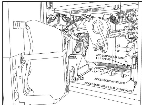
FIGURE 47: FRONT VALVE LOCATION ON X3 SERIES
