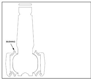
FIGURE 29: LOWER A-ARM BALL JOINT
