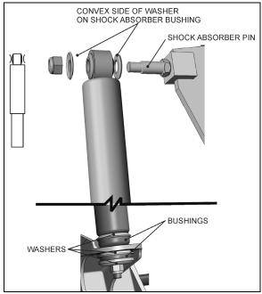
FIGURE 39: TYPICAL SHOCK ABSORBER SETUP 16009
