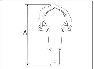
FIGURE 30: UPPER A-ARM BALL JOINT 16116
