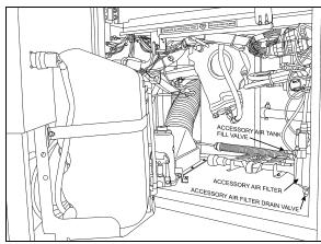
FIGURE 47: FRONT VALVE LOCATION ON X3 SERIES 12210
