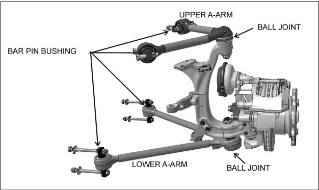
FIGURE 25: A-ARM JOINT IDENTIFICATION
