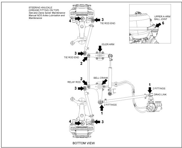
FIGURE 20: LUBRICATION FITTINGS LOCATION
