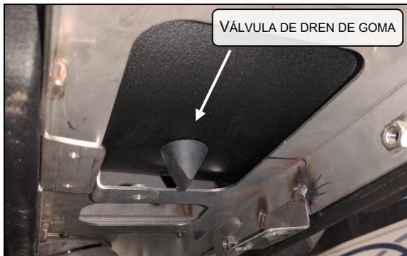
FIGURA 28 VÁLVULA DE DREN DE GOMA BAJO EL FILTRO
