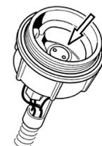
8. Aplique aceite de motor limpio al empaque nuevo del cubo de separación de agua. **No instale filtros de combustible previos a GHG17 en motores GHG17.**
