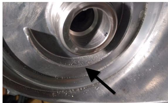
Partículas de aluminio en el restrictor del filtro de combustible (Carcasa de filtro de combustible)
