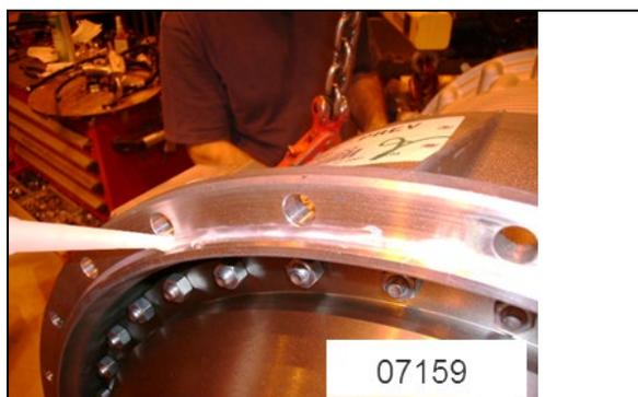
FIGURA 12: APLICACIÓN DE SILICÓN A LA CARCASA DE LA TRANSMISIÓN
