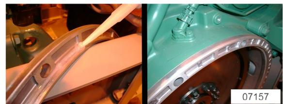
FIGURA 11: INSTALACIÓN DEL ESPACIADOR
