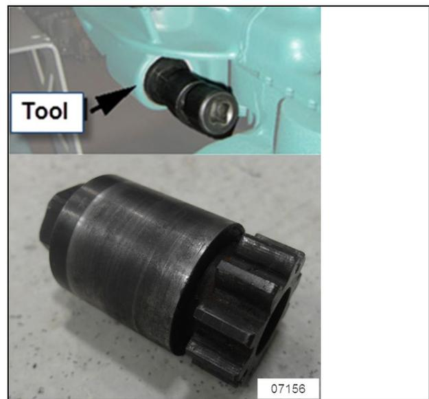
FIGURA 10: HERRAMIENTA DE GIRO DEL MOTOR VOLVO #88800014
