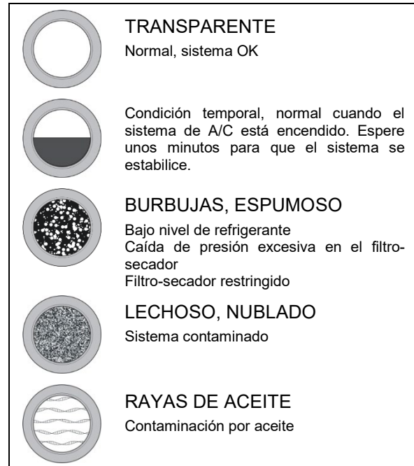
FIGURA 50: CONDICIONES QUE SE PUEDEN OBSERVAR EN LA MIRILLA DEL INDICADOR DE HUMEDAD
