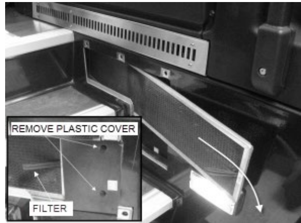
FIGURA 18: RETIRO DE FILTROS DE AIRE DE LA SECCIÓN DEL CONDUCTOR
