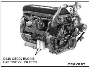
FIGURE 7: D13N OBD20 OIL FILTER CONFIGURATION
