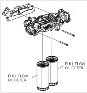
FIGURE 9: D13N OBD20 OIL FILTERS
