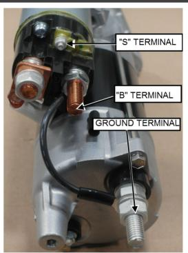
FIGURE 4: TERMINAL IDENTIFICATION
