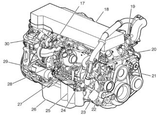
FIGURE 1: D13H ENGINE OVERVIEW, TURBO SIDE
