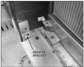
FIGURE 49: RADIATOR DOOR LOWER HINGE BRACKET
