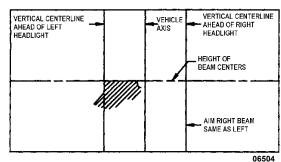
FIGURE 96: LOWER BEAM HIGH-INTENSITY ZONE **PROPER LOCATION ON SCREEN**
