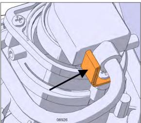
FIGURE 88: CONNECTOR STOPPER
