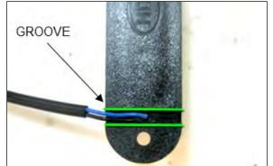
FIGURE 111: ROUTE THE WIRES IN THE GROOVE UNDER THE SEALED UNIT BODY
