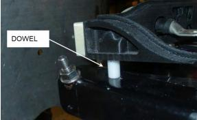
FIGURE 53: DOWEL ON ANGLE
