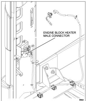
FIGURE 66: ENGINE BLOCK HEATER CONNECTION
