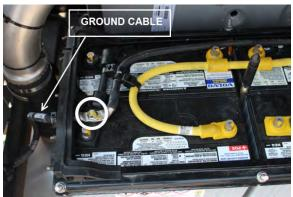
FIGURE 44: DISCONNECT GROUND CABLE FIRST
