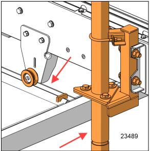
FIGURE 62: DROP THE REAR SIDE ON RAILS
