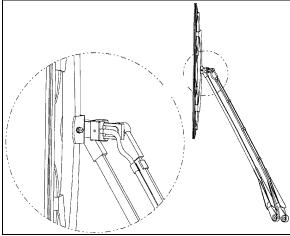
FIGURE 38: WINDSHIELD WIPER (MOTOR SIDE)
