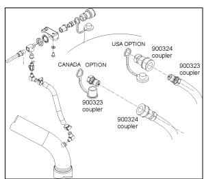
FIGURE 30: SUMP TANK FILL CONNECTION
