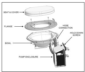
FIGURE 28: SUMP TANK PUMP ACCESS
