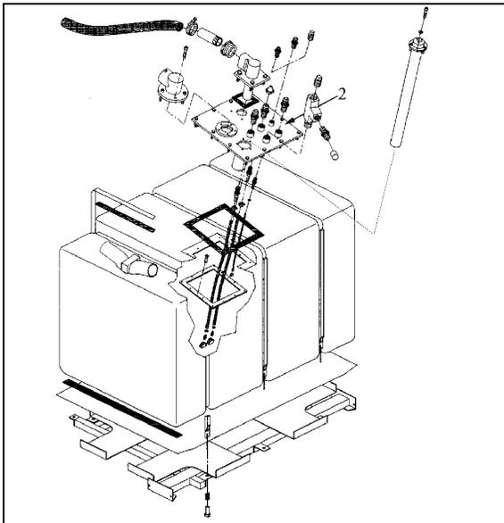
FIGURE 14: 222 US GALLONS FUEL TANK 03048
