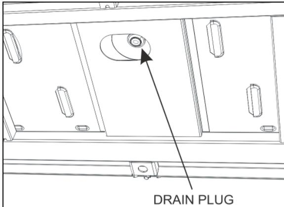
FIGURE 19: FUEL TANK DRAIN PLUG
