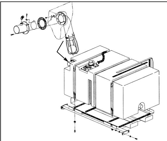
FIGURE 15: 208 US GALLONS FUEL TANK 03094
