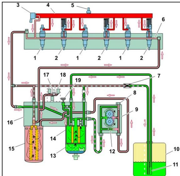
FIGURE 1: FUEL SYSTEM SCHEMATIC (VOLVO D13 ENGINE)
