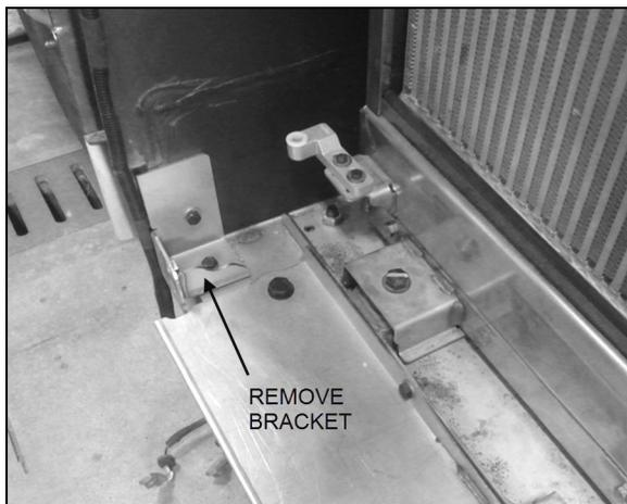
FIGURE 49: RADIATOR DOOR LOWER HINGE BRACKET
