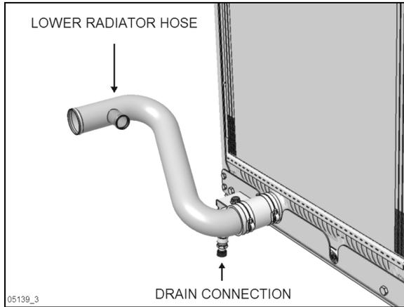
FIGURE 29: COOLANT DRAIN EXTRACTOR CONNECTION
