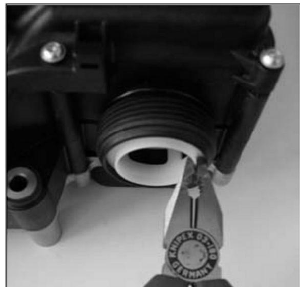
**FIGURE 13 : PUMP ASSEMBLY FILTER ELEMENT**
