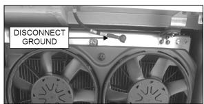
FIGURE 47: COOLING ASSEMBLY GROUND
