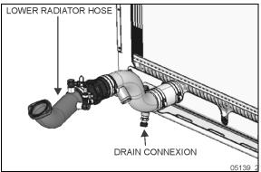
FIGURE 44: COOLANT DRAIN EXTRACTOR CONNECTION
