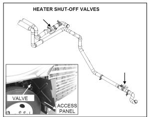
FIGURE 43: HEATER SHUT-OFF VALVES POSITION
