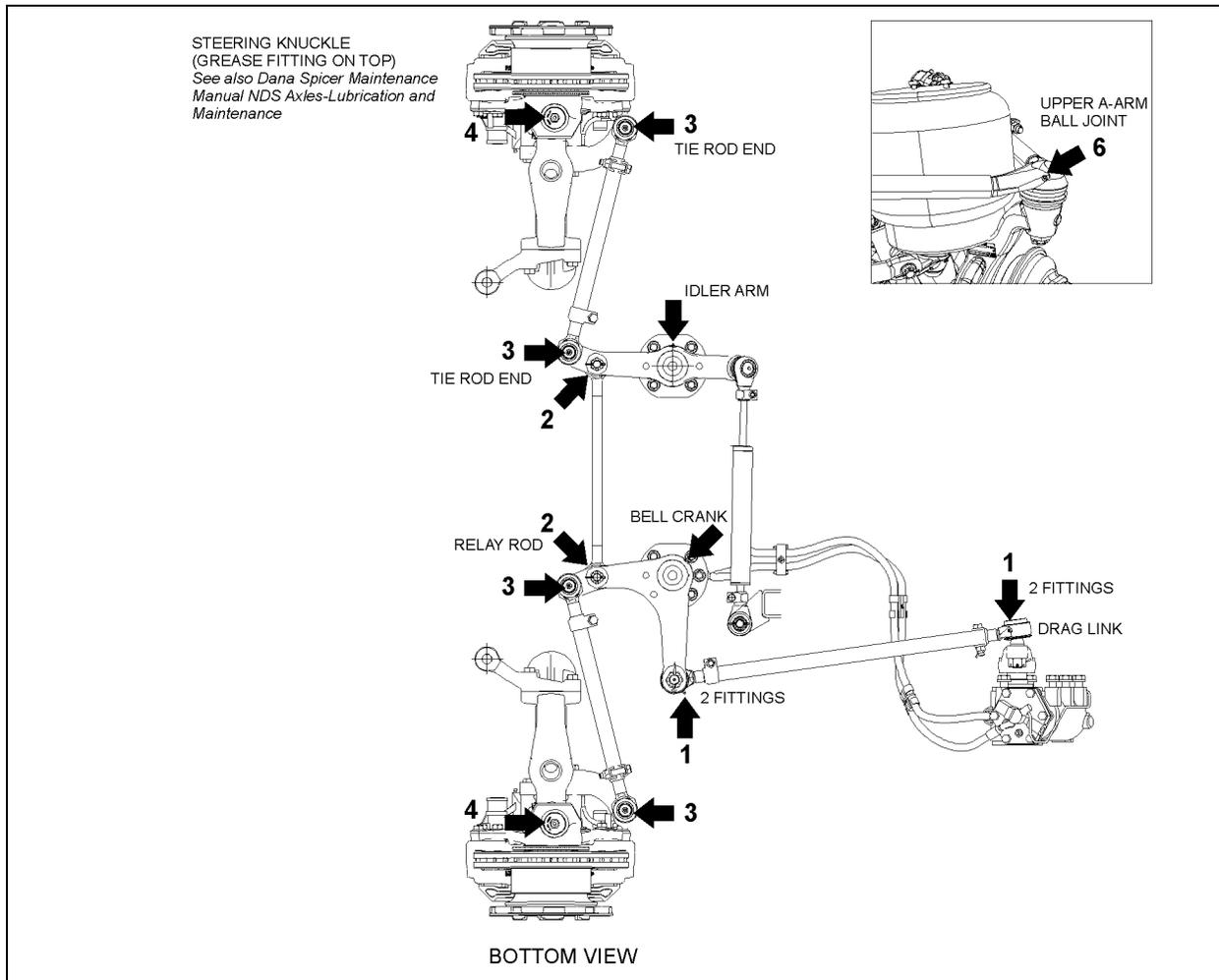
FIGURE 20: LUBRICATION FITTINGS LOCATION 16046
