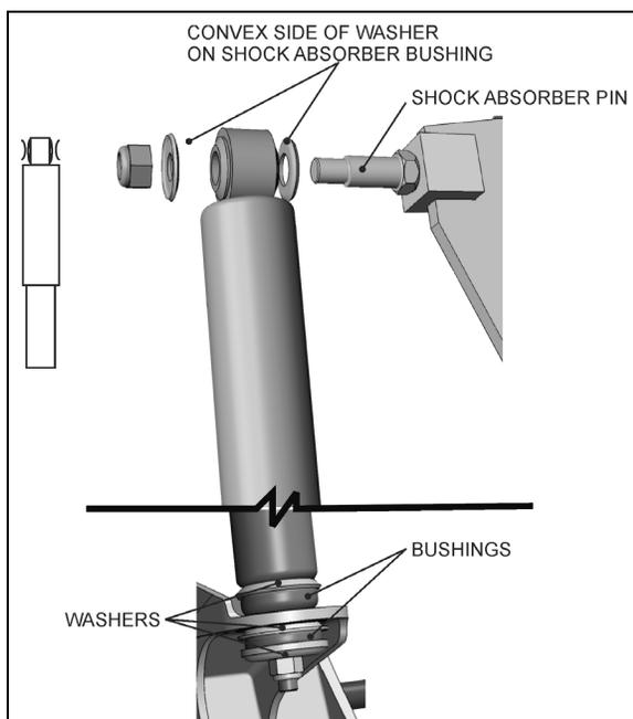
FIGURE 39: TYPICAL SHOCK ABSORBER SETUP 16009
