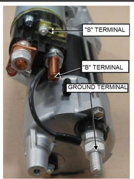
FIGURE 4: TERMINAL IDENTIFICATION
