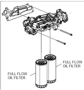
FIGURE 9: D13N OBD24 OIL FILTERS
