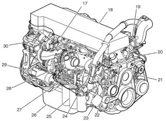
FIGURE 1: D13H ENGINE OVERVIEW. TURBO SIDE
