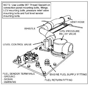
FIGURE 33: FUEL TANK CONNECTION PANEL
