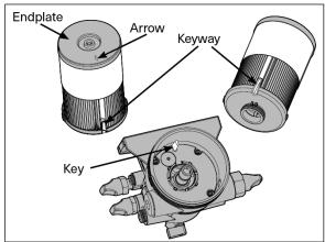
FIGURE 22: KEYWAY ON FUEL PRO 386 FILTER ONLY
