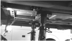
FIGURE 37: JACK STANDS UNDER THE FUEL TANK CRADLE
