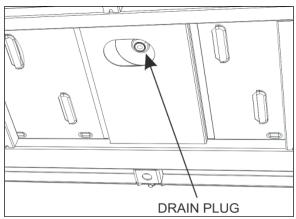
FIGURE 32: FUEL TANK DRAIN PLUG
