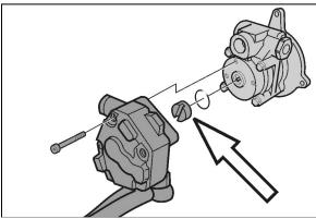
FIGURE 26: FUEL PUMP DRIVE AXLE
