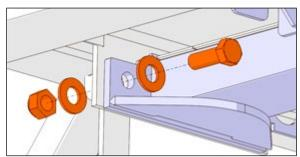
FIGURE 40: LONGITUDINAL SCREWS, 4 LOCATIONS
