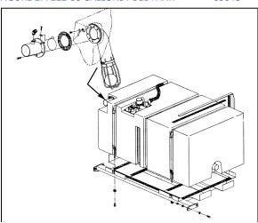
FIGURE 28: 203 US GALLONS FUEL TANK
