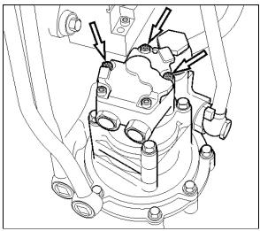
FIGURE 25: FUEL PUMP REMOVAL
