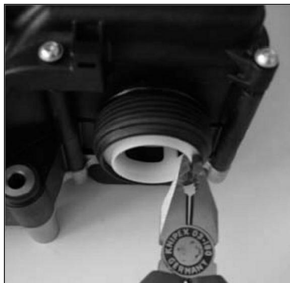
FIGURE 13 : PUMP ASSEMBLY FILTER ELEMENT
