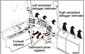
FIGURE 82: DRIVER UNIT AIR CIRCULATION
