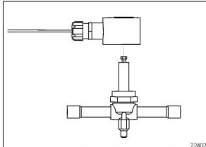
FIGURE 70: TYPICAL REFRIGERANT SOLENOID VALVE
