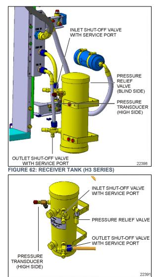
**FIGURE 63 RECEIVER TANK X3 SERIES**
