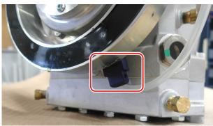
PROPER CABLE CONNECTOR POSITION
