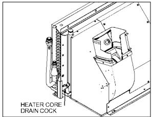
FIGURE 94: HEATER CORE DRAIN COCK LOCATION
