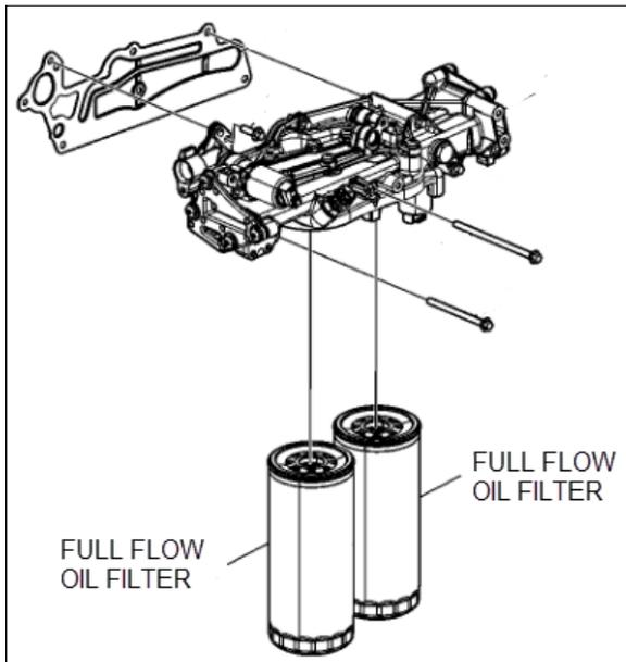
FIGURE 9: D13N OBD24 OIL FILTERS
