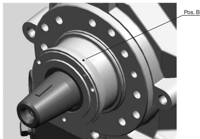
Abb. 3 Austrittsbohrung Leakageöl am Abschlussdeckel Fig. 3 Exit hole for leakage oil at the sealing cover Fig. 3 L'orifice de sortie pour l'huile de fuite dans le couvercle de fermeture
