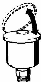
GODET DU DISPOSITIF DE DÉMARRAGE À FROID
