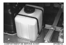
Les gicleurs sont situés sous les bras des essuie-glaces. Les gicleurs des pare-brise supérieurs et inférieurs sont commandés séparément et possèdent leur propre système de pompage relié au même réservoir.
