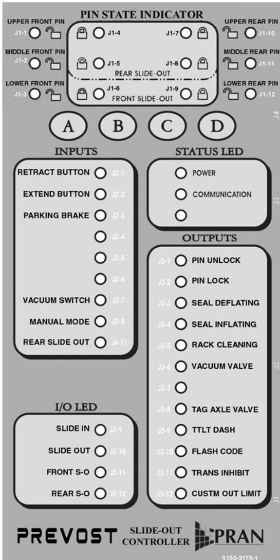
SLIDE-OUT LOGIC CONTROLLER INTERFACE DISPLAY
