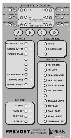
SLIDE-OUT LOGIC CONTROLLER INTERFACE DISPLAY
