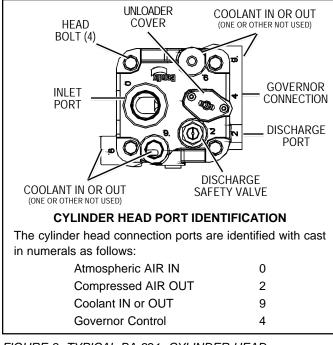
FIGURE 8- TYPICAL BA-921 CYLINDER HEAD
