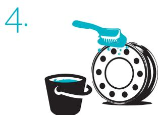
Répartir uniformément ALclean sur la roue avec une brosse (type ALbrush2) et frotter pendant quelques minutes.
