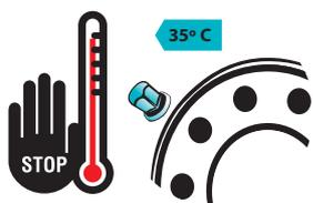
Laissez refroidir les roues jusqu'à ce que leur température soit de 35° C.
