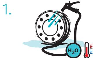
Vérifiez la faible température de la roue. Détrempez abondamment à l'eau chaude et privilégiez un nettoyeur haute pression.
