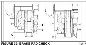
FIGURE 39: BRAKE PAD CHECK
