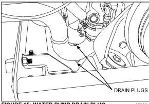
FIGURE 15: WATER PUMP DRAIN PLUG
