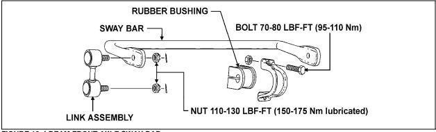
FIGURE 10: I-BEAM FRONT AXLE SWAY BAR
