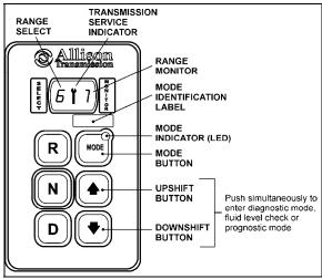
FIGURE 2: ALLISON TRANSMISSION CONTROL PAD 07142
