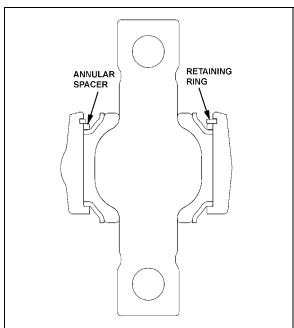
FIGURE 25: LOWER A-ARM BALL JOINTS
