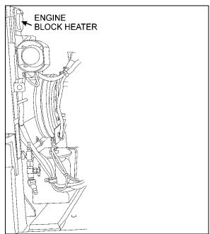
FIGURE 23: ELECTRIC HEATER PLUG LOCATION 06639
