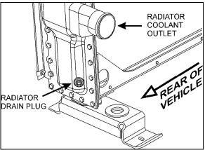
FIGURE 18: RADIATOR DRAIN PLUG
