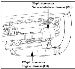
FIGURE 16: MOTOR CONTROL MODULE (MCM) 0114
