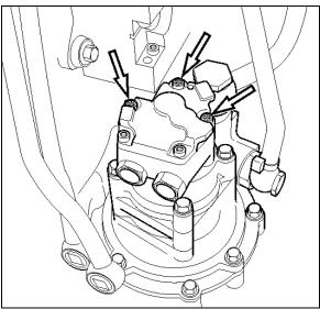
FIGURE 5: FUEL PUMP REMOVAL
