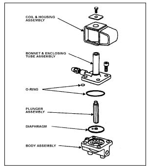
FIGURE 31: REFRIGERANT SOLENOID VALVE
