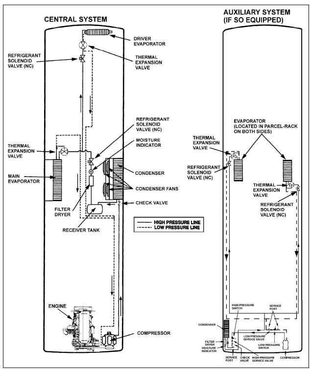
FIGURE 16: REFRIGERANT CIRCUIT (CENTRAL AND AUXILIARY SYSTEMS)
