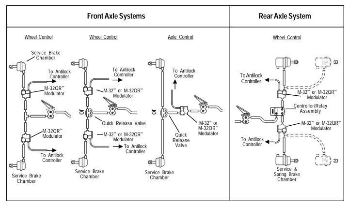
FIGURE 3: TYPICAL WHEEL AND AXLE CONTROL SYSTEMS
