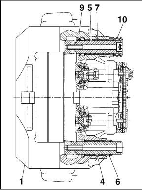
FIGURE 35: CALIPER GUIDANCE
