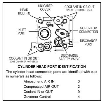
FIGURE 8- TYPICAL BA-921 CYLINDER HEAD
