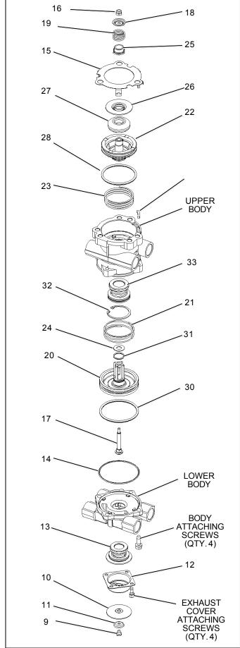
9 ATTACHI SCREW (QTY.4 FIGURE 5 - E-8P BRAKE VALVE - EXPLODED VIEW
