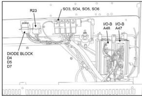
FIGURE 15: ENTRANCE DOOR & WIPER CONTROL PANEL 06619
