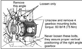
FIGURE 27: RIGHT ANGLE GEARBOX MOUNTING 05126
