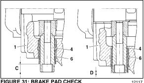
FIGURE 31: BRAKE PAD CHECK
