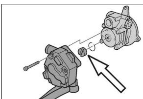
FIGURE 14: FUEL PUMP DRIVE AXLE
