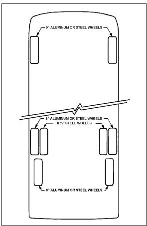
FIGURE 1: ALUM/STEEL WHEEL ARRANGEMENT 1300
