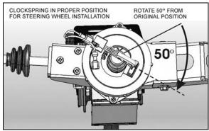
FIGURE 14: PROPER CLOCKSPRING POSITION
