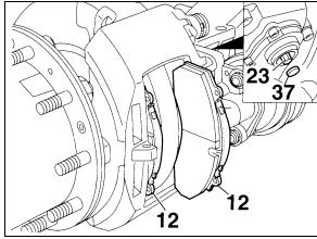
FIGURE 37: PAD INSTALLATION
