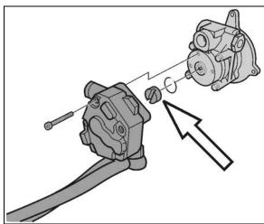
FIGURE 6: FUEL PUMP DRIVE AXLE
