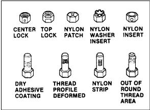
FIGURE 15 : SELF-LOCKING FASTENERS
