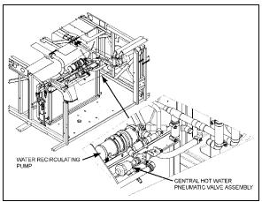
FIGURE 45: PUMP LOCATION (CENTRAL A/C)
