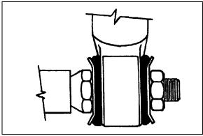
FIGURE 41: TYPICAL SHOCK ABSORBER SETUP
