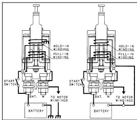
Figure 5 - SOLENOID CIRCUIT (GROUND-FLOAT TYPE)
