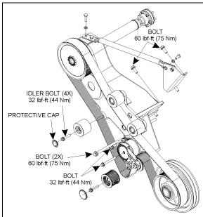
FIGURE 21: TIGHTENING SPECIFICATION (DDC S60 ENGINE) 05140
