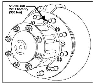
FIGURE 10: TORQUE SPECIFICATION
