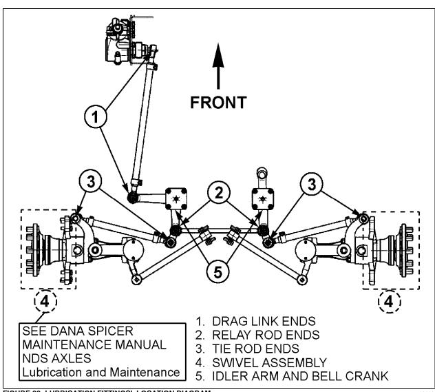
FIGURE 22: LUBRICATION FITTINGS' LOCATION DIAGRAM
