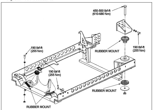
FIGURE 25: DDC SERIES 60 POWER PLANT CRADLE INSTALLATION
