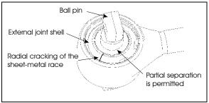
FIGURE 24: A-ARM BALL JOINTS
