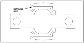
FIGURE 26: UPPER A-ARM BALL JOINTS
