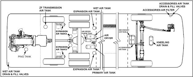
FIGURE 50: I-BEAM FRONT SUSPENSION AIR TANKS LOCATION
