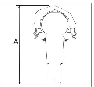
FIGURE 28: UPPER A-ARM CENTRAL BALL JOINT 1611
