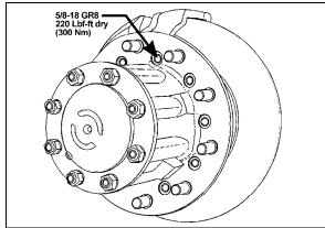
FIGURE 41: TORQUE SPECIFICATION
