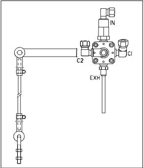
FIGURE 48: REAR HEIGHT CONTROL VALVE
