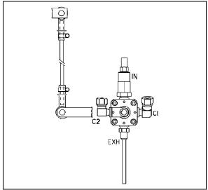
FIGURE 47: FRONT HEIGHT CONTROL VALVE
