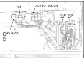
FIGURE 10: ENTRANCE DOOR & WIPER CONTROL **PANEL**
