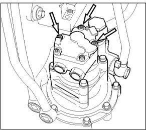
FIGURE 13: FUEL PUMP REMOVAL
