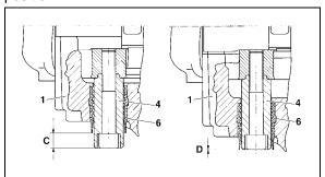
FIGURE 25: BRAKE PAD CHECK
