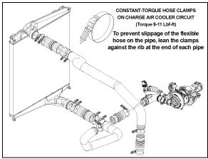
FIGURE 10: CHARGE AIR COOLER HOSE CLAMPS (VOLVO D13)
