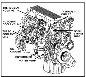
FIGURE 2: COOLING SYSTEM COMPONENTS (DDC S60 ENGINE) 05116
