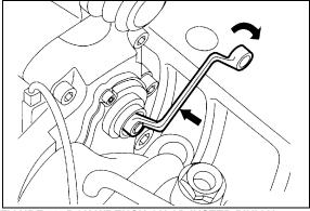
FIGURE 29: BOX WRENCH ON ADJUSTER PINION
