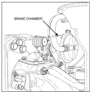
FIGURE 42: FRONT AXLE BRAKE AIR CHAMBER
