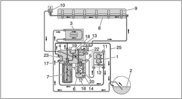
FIGURE 7: FUEL SYSTEM SCHEMATIC (VOLVO D13 ENGINE)
