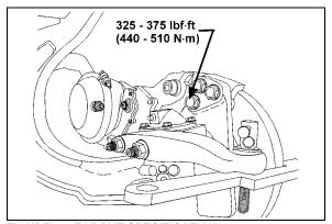
FIGURE 40: TORQUE SPECIFICATION
