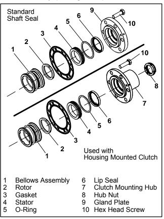
Figure 3-7. Shaft Seal
