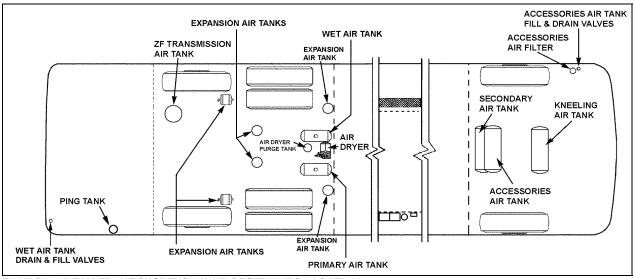
FIGURE 2: I-BEAM FRONT SUSPENSION AIR RESERVOIRS LOCATION
