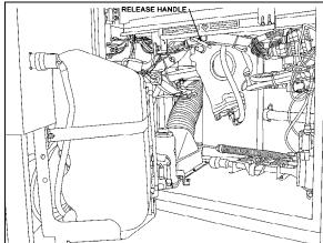
FIGURE 9: FRONT BUMPER RELEASE HANDLE
