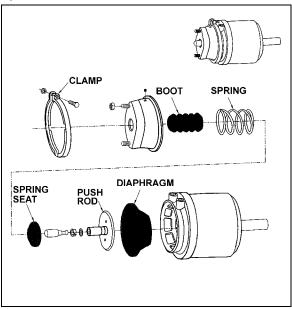
FIGURE 43: DRIVE AXLE BRAKE AIR CHAMBER
