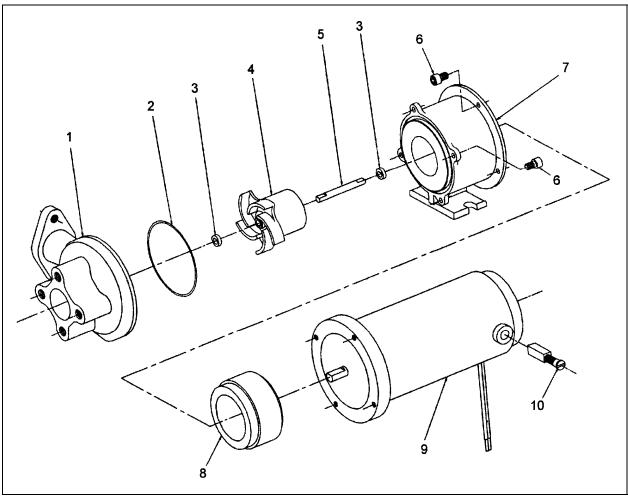
FIGURE 46: WATER RECIRCULATING PUMP (CENTRAL A/C)
