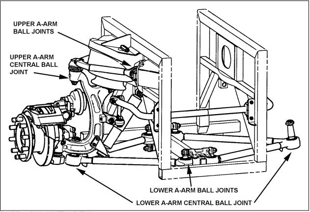
FIGURE 23: BALL JOINTS LOCATION
