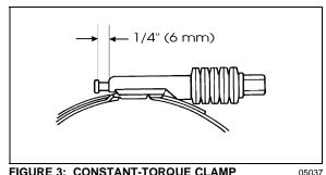
FIGURE 3: CONSTANT-TORQUE CLAMP
