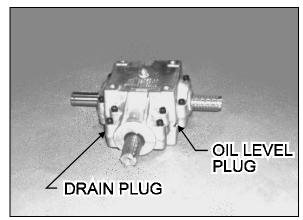
FIGURE 14: FAN GEARBOX
