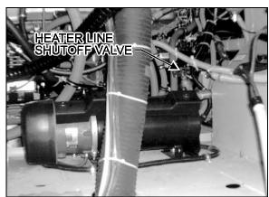
FIGURE 5: HEATER LINE SHUTOFF VALVE
