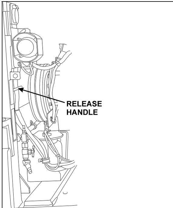
OPENING THE ENGINE COMPARTMENT REAR DOORS FROM R.H. SIDE DOOR
