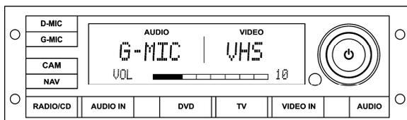
L'unité de commande audio-vidéo VSS-05 Video & Sound Selector permet au conducteur de sélectionner la source audio, audio/vidéo ou vidéo de divertissement et d'effectuer les réglages audio (volume, niveau des basses, des aigus, etc.) pour la section des passagers. Cette unité permet également de contrôler le lecteur DVD, un syntoniseur TV, les microphones et des systèmes audio ou vidéo auxiliaires.
