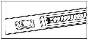
NAVIGATOR'S AIR REGISTER & FAN SPEED SELECTOR
