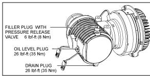
RIGHT ANGLE GEARBOX OIL LEVEL CHECK
