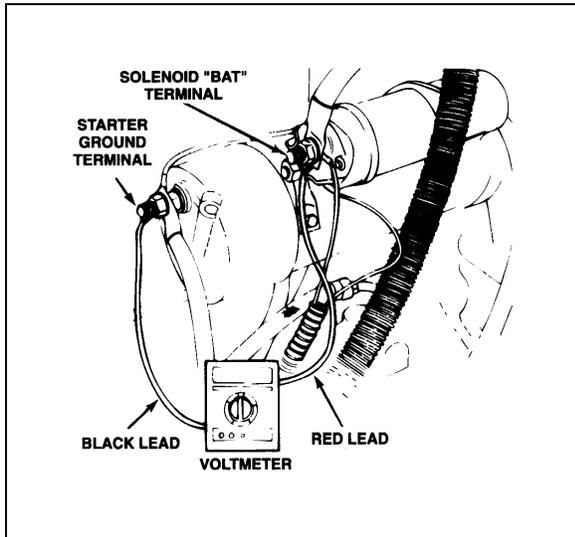
FIGURE 89: CRANKING MOTOR AVAILABLE VOLTAGE TEST
