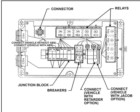
FIGURE 37: DDEC III JUNCTION BOX 06121
