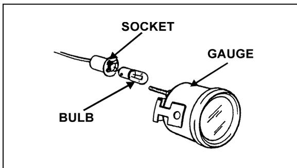
FIGURE 107: GAUGE LIGHT BULB
