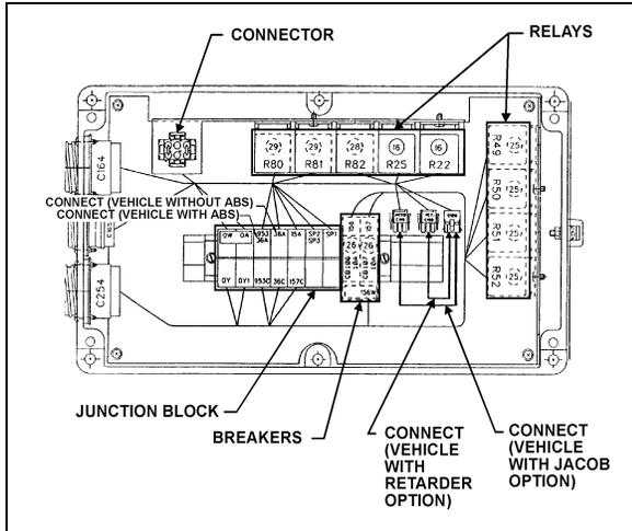
FIGURE 26: DDEC III JUNCTION BOX 06121
