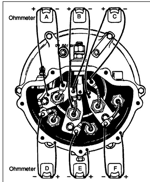
FIGURE 69: DIODES TEST
