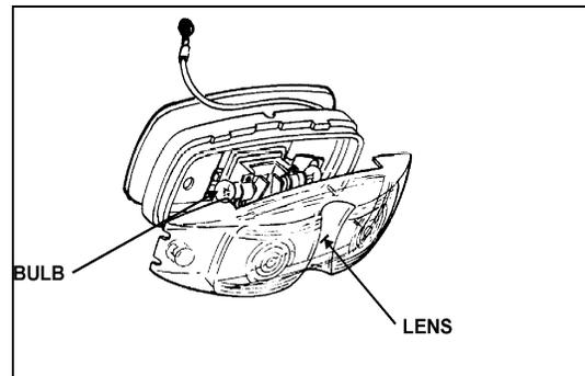
FIGURE 100: MARKER LIGHT / SIDE DIRECTIONAL LIGHT
