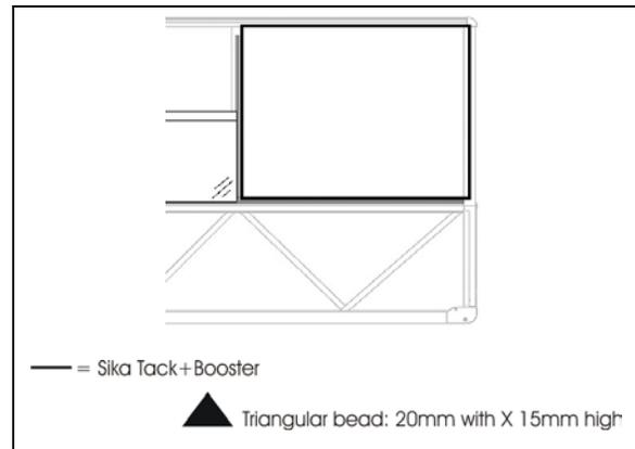
**FIGURE 56: FACE FIXED WINDOW INSTALLATION – SIKA TACK+BOOSTER**
