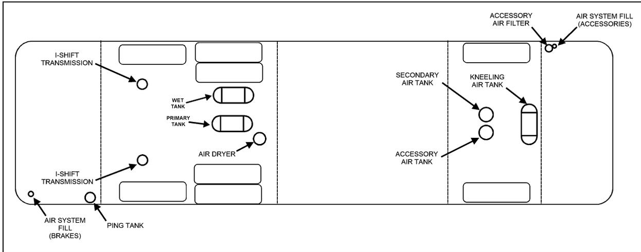
FIGURE 2: I-BEAM FRONT SUSPENSION AIR RESERVOIRS LOCATION
