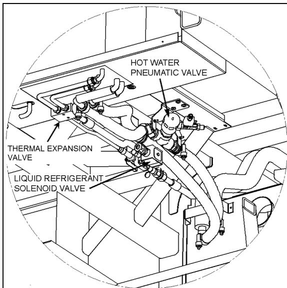
FIGURE 30: DRIVER'S EVAPORATOR LIQUID SOLENOID VALVE 22324
