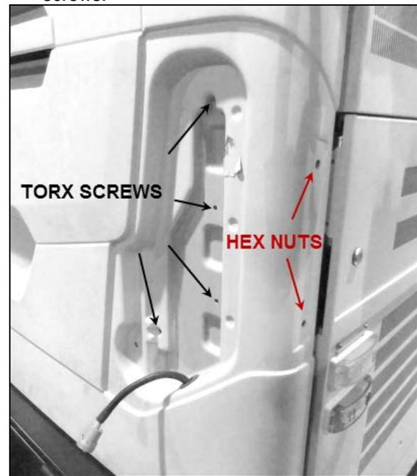
FIGURE 40: TAILLAMP POD RETAINING SCREWS & NUTS
