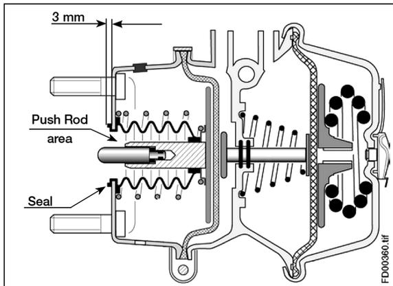
FIGURE 30: DRIVE AXLE BRAKE AIR CHAMBER 12126
