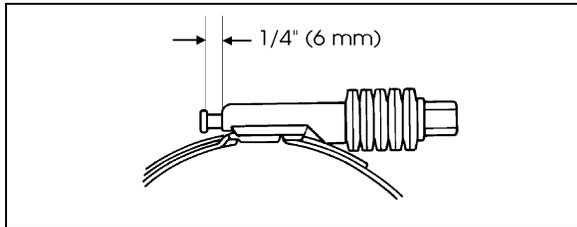
FIGURE 3: CONSTANT-TORQUE CLAMP
