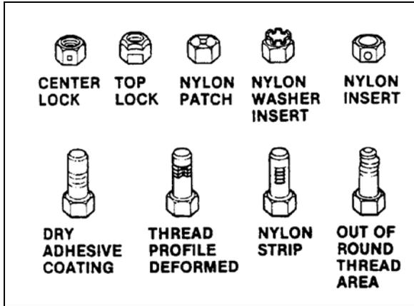
FIGURE 14: SELF-LOCKING FASTENERS 00004
