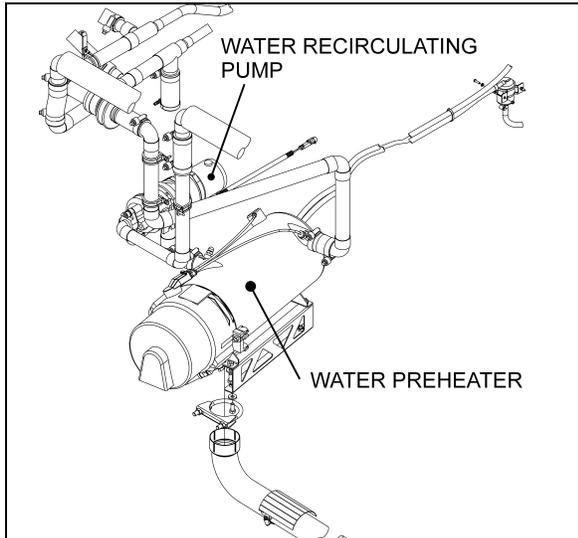
FIGURE 48: PUMP LOCATION (CENTRAL A/C) 22331
