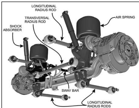
FIGURE 1: FRONT I-BEAM AXLE SUSPENSION 16105
