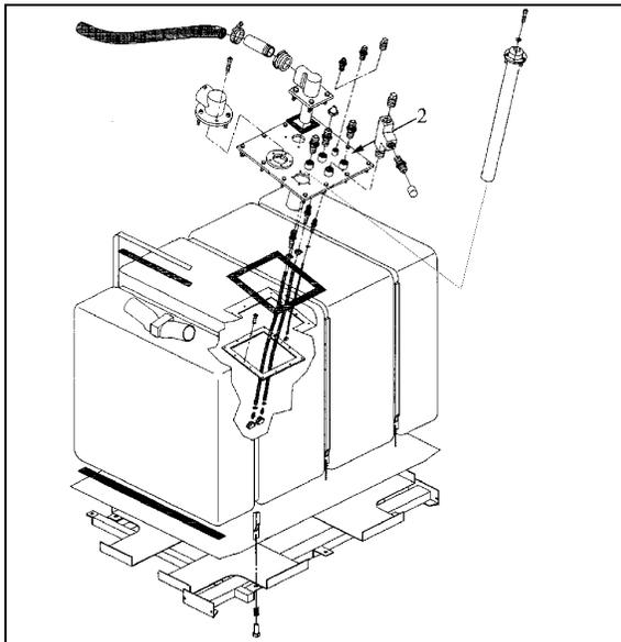
FIGURE 11: 235 US GALLONS FUEL TANK 03048
