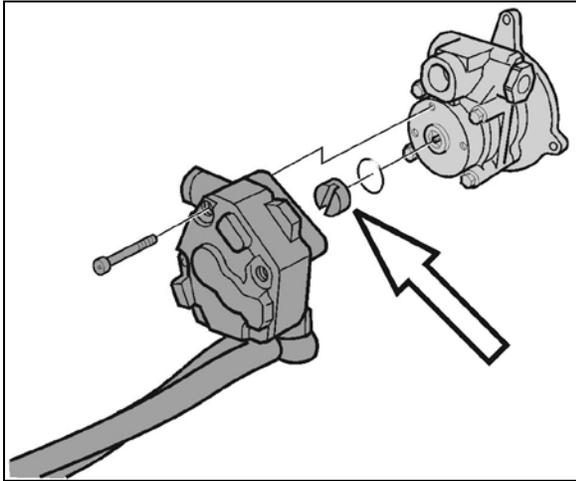
FIGURE 6: FUEL PUMP DRIVE AXLE
