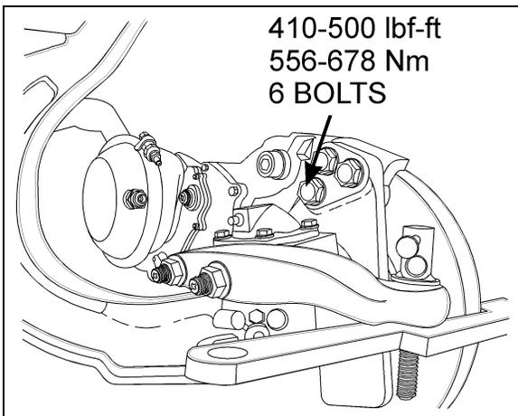
FIGURE 27: TORQUE SPECIFICATION<sup>2145</sup>
