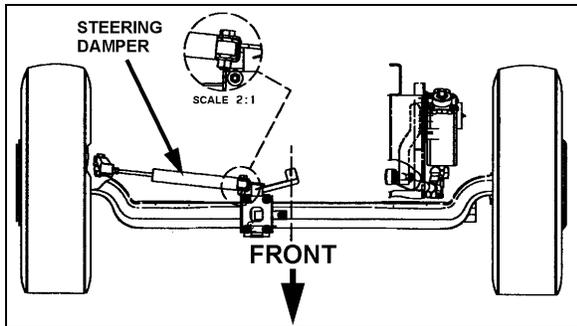
FIGURE 26: STEERING STABILIZER (DAMPER) 14053
