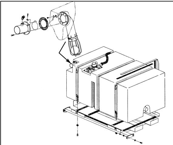
FIGURE 12: 208 US GALLONS FUEL TANK 03094
