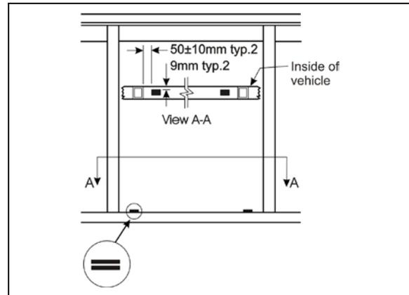
FIGURE 61: AWNING WINDOW - RUBBER BUMPER INSTALLATION
