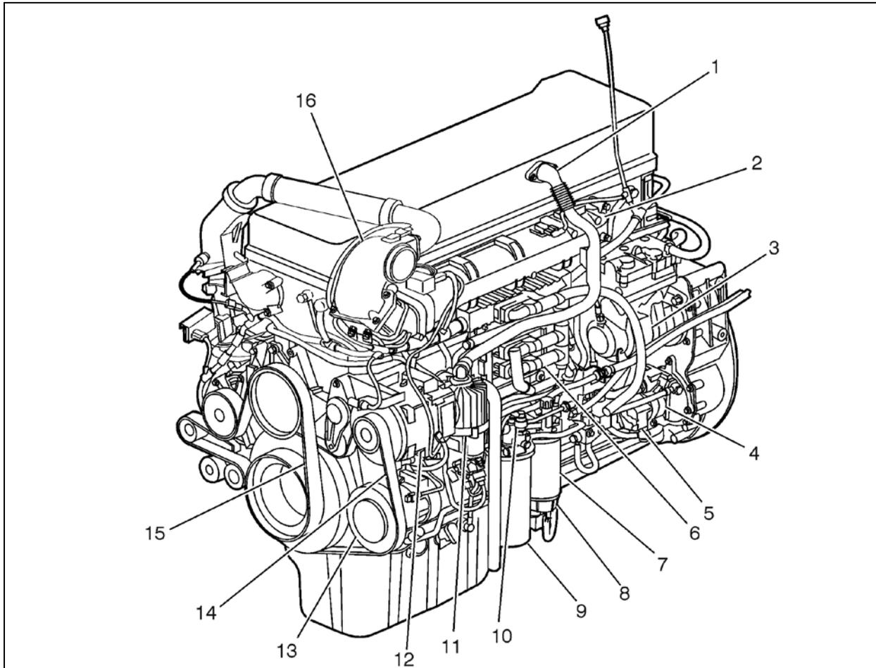
FIGURE 3: D13H ENGINE OVERVIEW, ALTERNATOR SIDE (TYPICAL)
