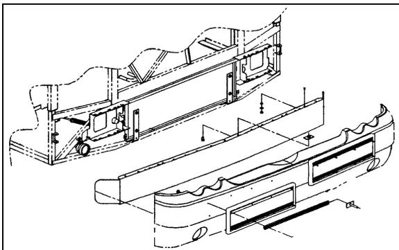
FIGURE 54: FRONT BUMPER REMOVAL
