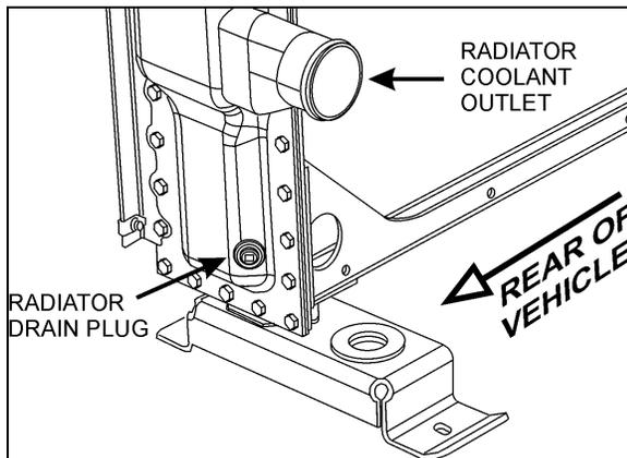
FIGURE 9: RADIATOR DRAIN PLUG 05139
