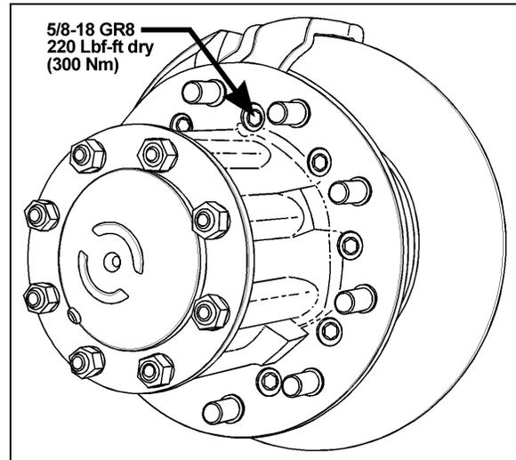
FIGURE 10: TORQUE SPECIFICATION
