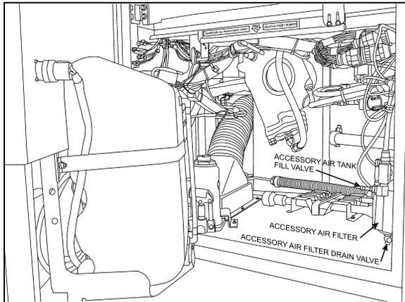
FIGURE 54: FRONT VALVE LOCATION 12210
