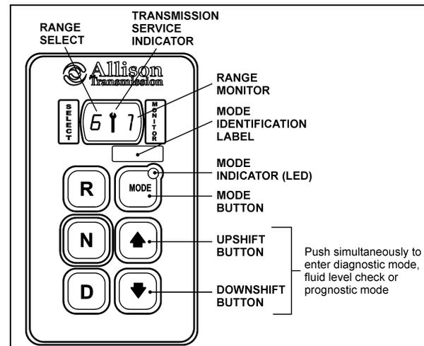
FIGURE 2: ALLISON TRANSMISSION CONTROL PAD
