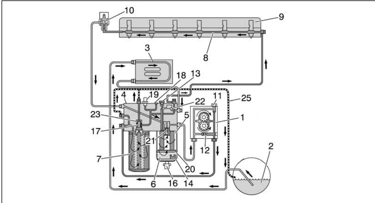
FIGURE 1: FUEL SYSTEM SCHEMATIC (VOLVO D13 ENGINE) 03086
