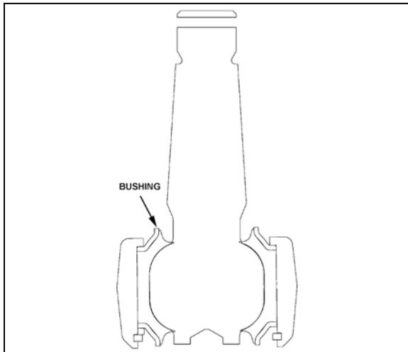
FIGURE 30: LOWER A-ARM BALL JOINT
