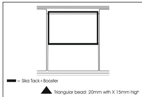
**FIGURE 57: FACE FIXED HALF-WINDOW INSTALLATION – SIKA TACK+BOOSTER**
