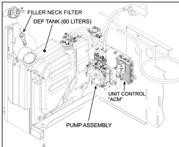
FIGURE 8: DEF TANK AND PUMP LOCATION
