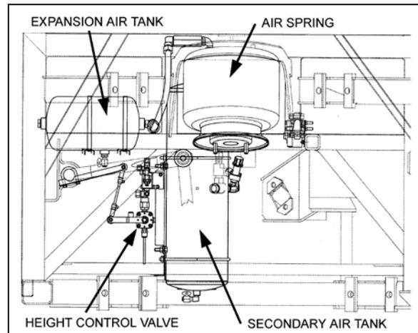
FIGURE 35: HEIGHT CONTROL VALVE LOCATION <sup>16057</sup>
