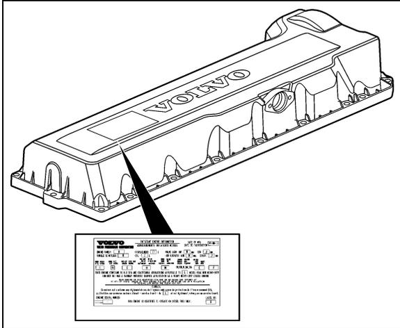
FIGURE 1: VOLVO D13 ENGINE DATA PLATE 00052
