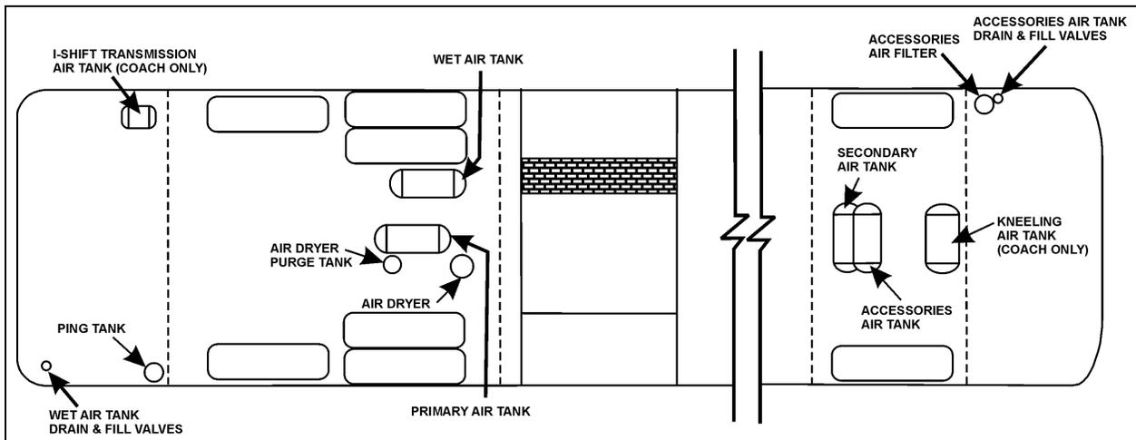
FIGURE 52: I-BEAM FRONT SUSPENSION AIR TANKS LOCATION
