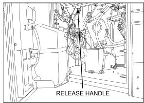
FIGURE 55: FRONT BUMPER RELEASE HANDLE
