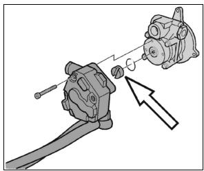
FIGURE 6: FUEL PUMP DRIVE AXLE
