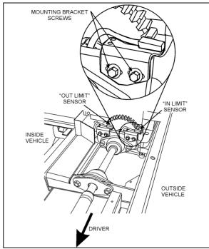
FIGURE 37: FRONT SLIDE-OUT SENSORS
