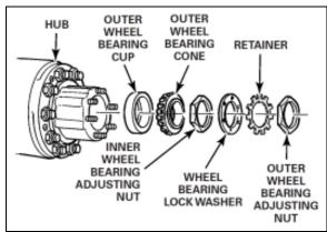
FIGURE 9: DRIVE AXLE WHEEL HUB
