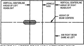
FIGURE 34: UPPER BEAM HIGH-INTENSITY ZONE PROPER LOCATION ON SCREEN
