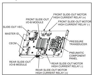
FIGURE 35: SLIDE-OUT CONTROL PANEL
