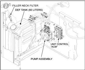
FIGURE 8: DEF TANK AND PUMP LOCATION
