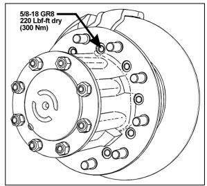
FIGURE 28: TORQUE SPECIFICATION 11030
