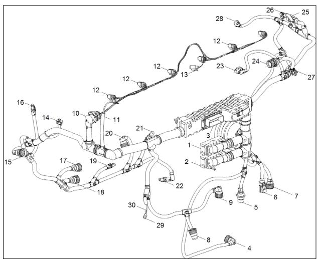
FIGURE 2: D13H ENGINE HARNESS
