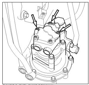
FIGURE 5: FUEL PUMP REMOVAL
