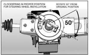
FIGURE 14: PROPER CLOCKSPRING POSITION
