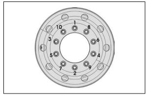
FIGURE 3: TIGHTENING SEQUENCE
