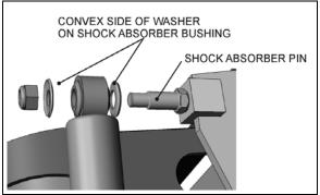
FIGURE 43: TYPICAL SHOCK ABSORBER SETUP 16009
