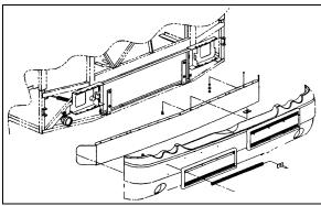
FIGURE 54: FRONT BUMPER REMOVAL
