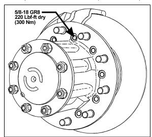
FIGURE 10: TORQUE SPECIFICATION
