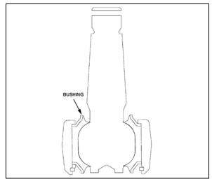
FIGURE 30: LOWER A-ARM BALL JOINT
