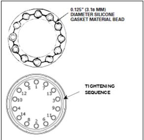
FIGURE 10: AXLE FLANGE TIGHTENING SEQUENCE
