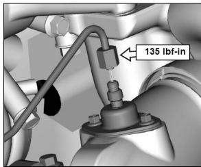
FIGURE 10: FUEL LINE FITTING
