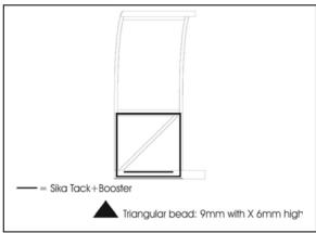
FIGURE 43: SIDE PANEL INSTALLATION - SIKA TACK+BOOSTER APPLICATION
