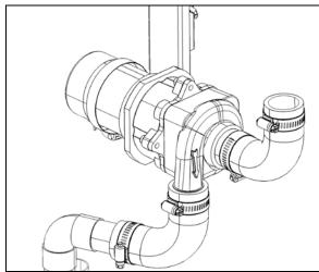
FIGURE 49: WATER RECIRCULATING PUMP (CENTRAL A/C)
