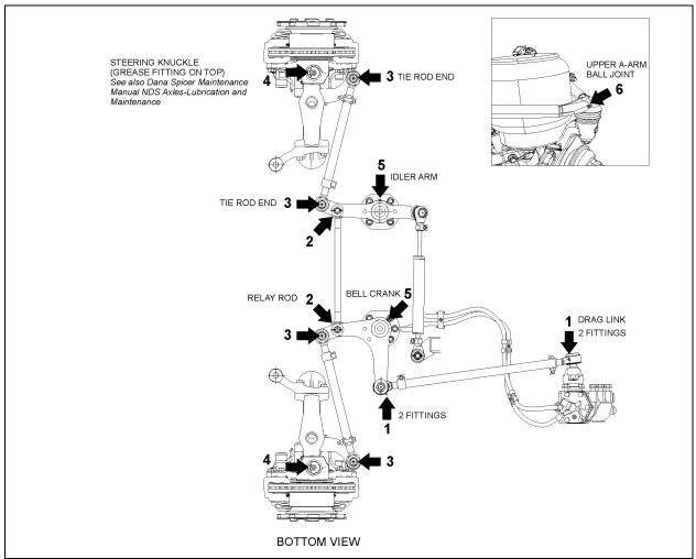
FIGURE 19: LUBRICATION FITTINGS LOCATION
