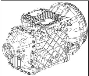
FIGURE 3: VOLVO I-SHIFT TRANSMISSION
