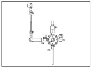
FIGURE 37: FRONT HEIGHT CONTROL VALVE
