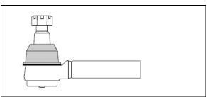
FIGURE 30: STRAIGHT BODY TYPE BALL JOINT
