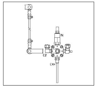
FIGURE 49: FRONT HEIGHT CONTROL VALVE
