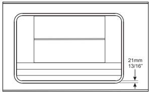
FIGURE 21: SLIDE-OUT LEVEL ADJUSTEMENT
