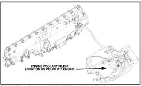
FIGURE 8: COOLANT FILTER (VOLVO D13)
