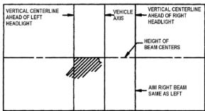
FIGURE 35: LOWER BEAM HIGH-INTENSITY ZONE PROPER LOCATION ON SCREEN 06504
