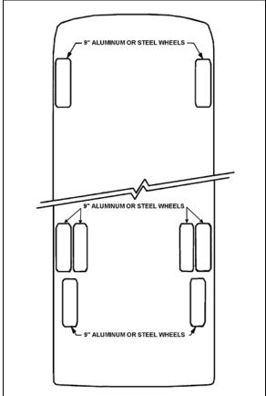
FIGURE 1: ALUM/STEEL WHEEL ARRANGEMENT 13001
