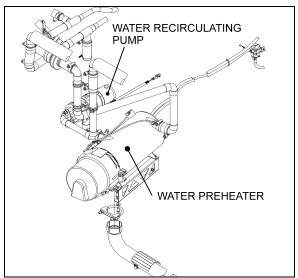
FIGURE 48: PUMP LOCATION (CENTRAL A/C)
