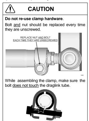
FIGURE 27: I-BEAM FRONT AXLE DRAG LINK
