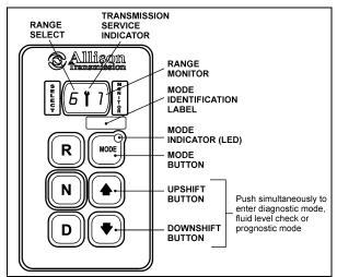
FIGURE 2: ALLISON TRANSMISSION CONTROL PAD
