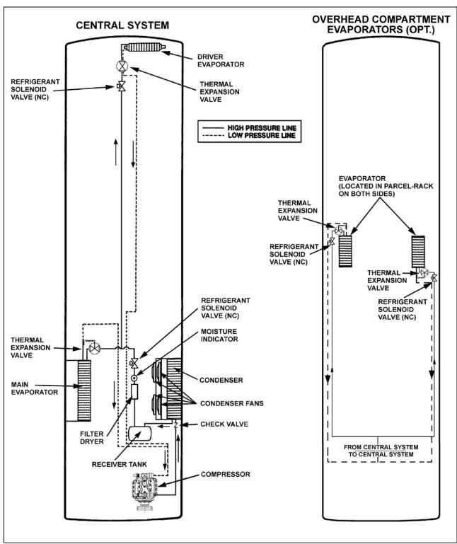
FIGURE 19: REFRIGERANT CIRCUIT (CENTRAL AND OVERHEAD COMPARTMENT)
