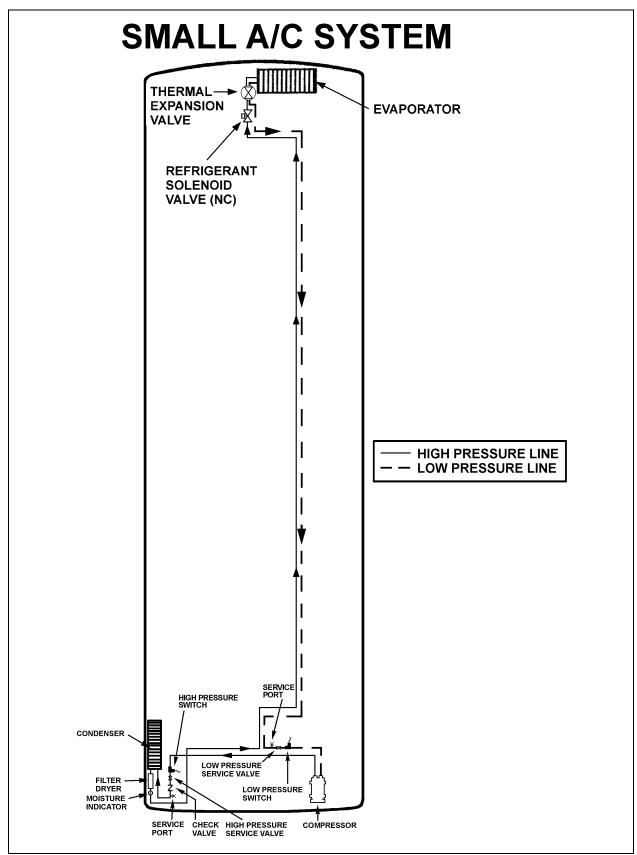
FIGURE 38: REFRIGERANT CIRCUIT (SMALL SYSTEM) 22350
