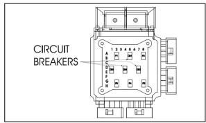
FIGURE 88: VEC CIRCUIT BREAKERS ON SLIDE-OUT CONTROL PANEL
