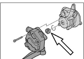
FIGURE 8: FUEL PUMP DRIVE AXLE
