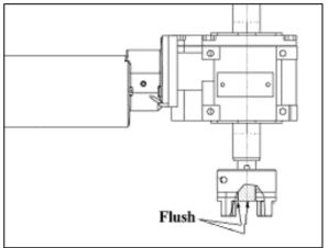
FIGURE 19: CLAMPING HUB POSITION ON GEARBOX SHAFT
