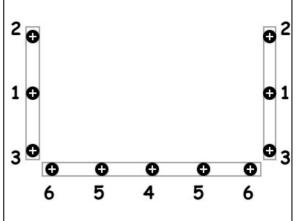
FIGURE 74: CORRECT TIGHTENING SEQUENCE
