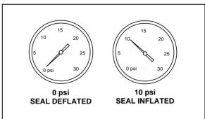
FIGURE 93: INFLATABLE SEAL PRESSURE GAGE
