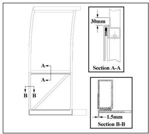
FIGURE 44: SIDE PANEL INSTALLATION
