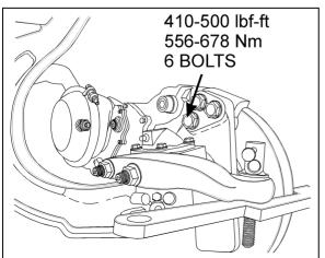
FIGURE 27: TORQUE SPECIFICATION2145
