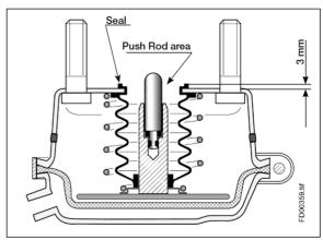
FIGURE 29: FRONT AXLE BRAKE AIR CHAMBER
