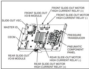
FIGURE 90: SLIDE-OUT CONTROL PANEL
