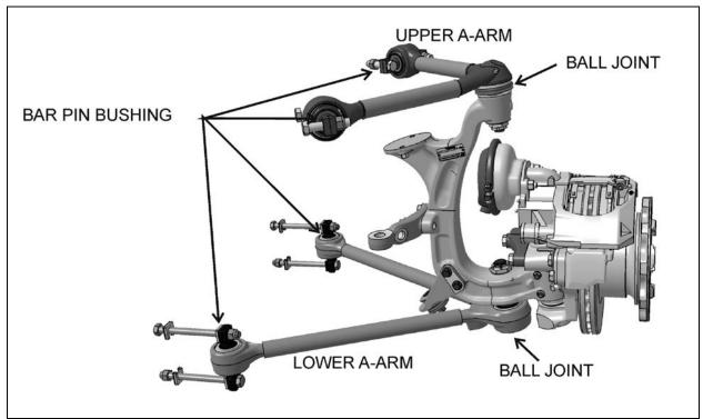
FIGURE 26: A-ARM JOINT IDENTIFICATION
