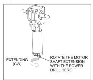
FIGURE 94: SLIDE-OUT MOTOR ROTATION
