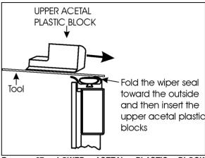
FIGURE 27: LOWER ACETAL PLASTIC BLOCK INSERTION
