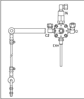
FIGURE 50: REAR HEIGHT CONTROL VALVE
