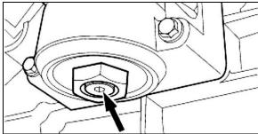
FIGURE 14: OIL FILTER HOUSING DRAIN PLUG
