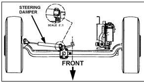
FIGURE 26: STEERING STABILIZER (DAMPER)
