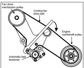
FIGURE 30: DRIVE BELT ROUTING (VOLVO D13 ENGINE)
