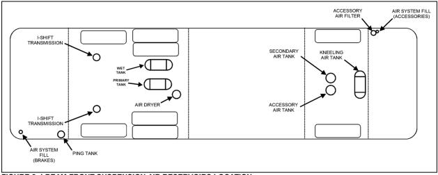
FIGURE 2: I-BEAM FRONT SUSPENSION AIR RESERVOIRS LOCATION
