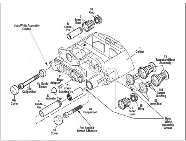
FIGURE 22: BRAKE COMPONENTS
