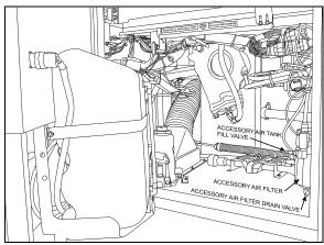
FIGURE 54: FRONT VALVE LOCATION
