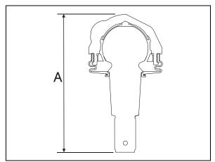
FIGURE 31: UPPER A-ARM BALL JOINT
