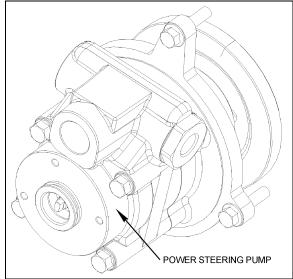
FIGURE 7: POWER STEERING PUMP
