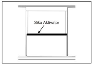
FIGURE 72: SLIDING WINDOW - SIKA AKTIVATOR
