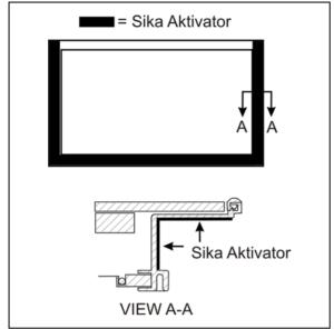
FIGURE 71: SLIDING WINDOW - SIKA AKTIVATOR
