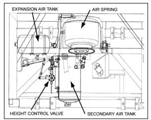
FIGURE 35: HEIGHT CONTROL VALVE LOCATION 16057
