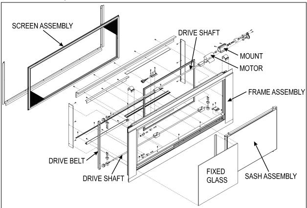
FIGURE 63: ELECTRIC SLIDING WINDOW EXPLODED VIEW
