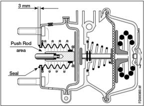
FIGURE 30: DRIVE AXLE BRAKE AIR CHAMBER 12
