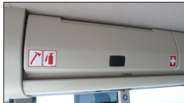
LA PRÉSENCE D'UN AUTOCOLLANT INDIQUE QU'UN EXTINCTEUR (OPTION) EST RANGÉ DANS CE PORTE-BAGAGES À MAIN
