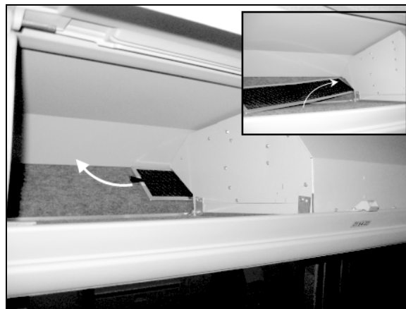
FILTRES À AIR DU SYSTÈME DE VENTILATION DES PORTE-BAGAGES
