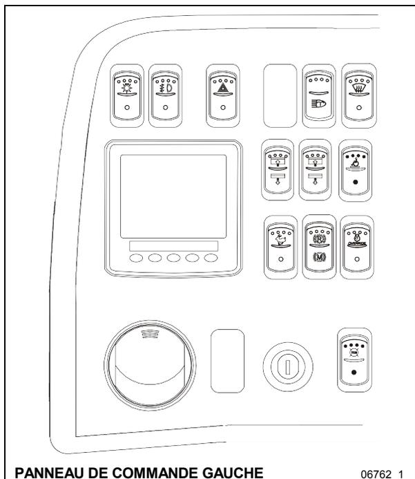
Le panneau de commande gauche du tableau de bord comprend les interrupteurs de commande pour la conduite de l'autocar. Il comprend également le commutateur d'allumage et un registre d'air réglable pour le conducteur.
