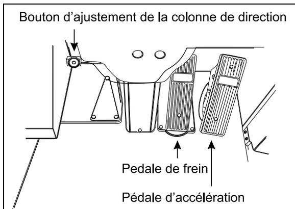
INCLINAISON ET RÉGLAGE TÉLESCOPIQUE
