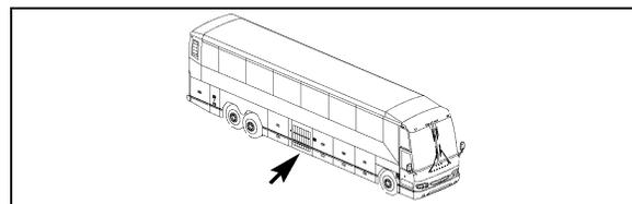
Pour ouvrir la porte du compartiment du condenseur, ouvrir préalablement la porte d'accès au col de remplissage du carburant. Déplacer la goupille du pêne vers la droite (voir étape 1 sur l'image). Abaisser le levier de verrouillage pour déverrouiller la porte (étape 2).
