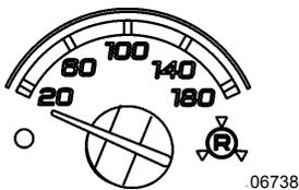
Indique la pression d'air du système de freinage arrière. La pression normale de fonctionnement se situe entre 122 et 140 psi.
