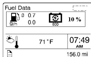
Lorsqu'équipé du système PRIME, le pourcentage du trajet réalisé avec de l'électricité régénérée est aussi affiché.
