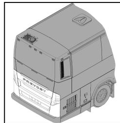
Pour ouvrir la porte arrière du compartiment moteur, ouvrir d'abord la porte d'accès au côté droit du moteur. Soulever le levier de déverrouillage vers le haut. Tirer le haut de la porte vers l'arrière.
