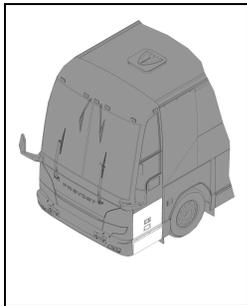
Ce compartiment peut être déverrouillé à l'aide de la clé des compartiments extérieurs. Le compartiment s'éclaire automatiquement à l'ouverture de la porte si le commutateur d'allumage est à la position ON ou ACC.
